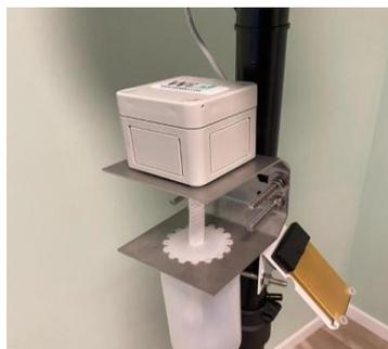
Fig. 2. Termometro a bulbo umido
