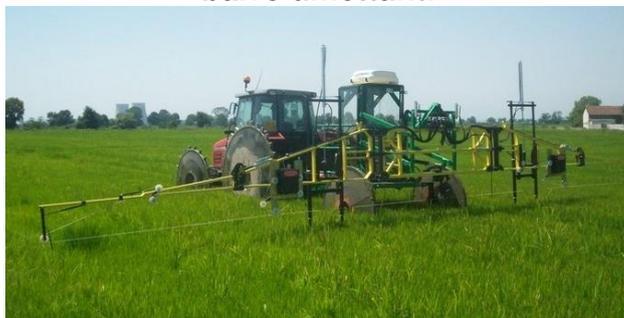
**attrezzature per la distribuzione di prodotti fitosanitari in forma solida o granulare**
