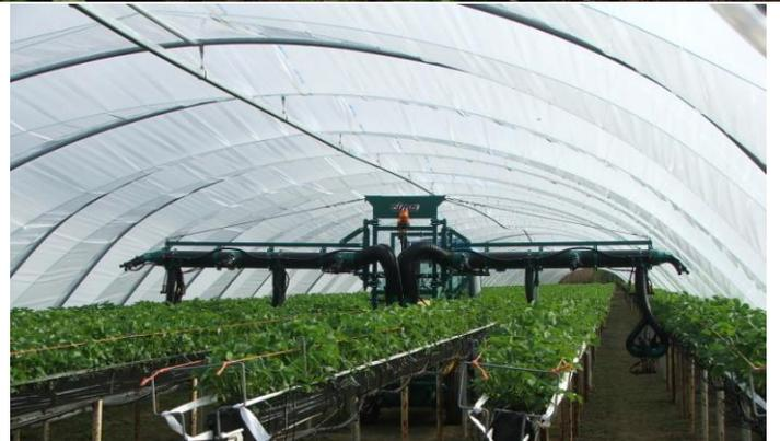
**irroratrici aeroassistite (a polverizzazione per pressione, pneumatica o centrifuga)**
